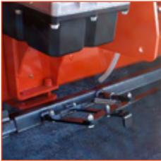
**DIRECTIONNEL FORCÉ:** Ce système de direction forcée indépendant relie le système de direction de la tonne au tracteur et fonctionnant dans les deux sens de marche.
