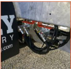
**REPARTITEUR:** Fournit une solution simple pour réduire le nombre de prises hydrauliques du tracteur nécessaires pour alimenter plusieurs fonctions.
