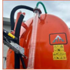
**JAUGES DE NIVEAU:** Jauge transparente de 100 mm pour afficher le volume de lisier à l'intérieur de la cuve.
