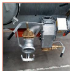
**HACHEUR VOGELSANG:** Hachoir Rota-Cut équipé d'un ramasse-pierres et d'une valve à fixation rapide de 6". Idéal pour hacher rapidement les matériaux fibreux à leur entrée afin de préparer une distribution homogène du lisier.
