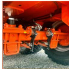
**SUSPENSION EPANDEUR TANDEM:** Équipé d'un robuste bogie à ressorts multi-lames autodirectionnel. Il offre une répartition optimale du poids, une stabilité et un confort et améliore également la maniabilité de l'épandeur. Des ensembles
