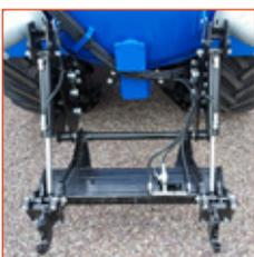
**ATTELAGE HYDRAULIQUE ARRIÈRE:** L'attelage permet la déconnexion rapide de l'applicateur, laissant le cadre hydraulique monté à l'arrière disponible pour se reconnecter à un autre système d'applicateur Abbey en cas de besoin.
