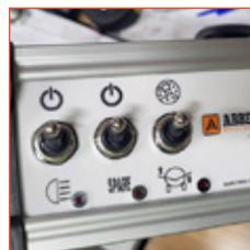
**BOITIER DE COMMANDES:** Boitier de commandes électriques pour les fonctions hydrauliques via un ensemble de vannes sans détection de charge et un simple boîtier de commande.
