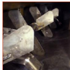
**BRASSEUR INTERNE:** Brasseur à palette interne qui agit le lisier pendant le transport, avec un entraînement hydraulique pour maintenir le produit liquide, en suspension et empêcher la sédimentation au fond de la cuve. L'ensemble du lisier est ainsi agité et la matière sèche reste en suspension. Cela
