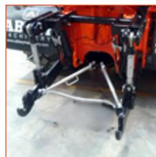
**ATTELAGE ROBUSTE:** Lors de l'ajout d'applicateurs plus lourds à l'arrière de l'épandeur, Abbey Machinery a la possibilité de mettre en place un système renforcé pour un support supplémentaire et une plus grande robustesse.
