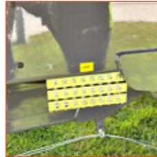
**BLOC DE GRAISSAGE CENTRAL:** Un bloc de graissage central est désormais disponible. Il permet de simplifier la maintenance, à prolonger la durée de vie et à rendre la tonne plus fiable.
