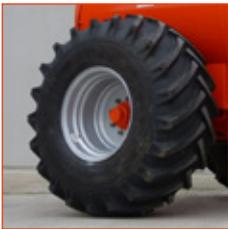
**ROUES:** Le choix des roues est essentiel pour une utilisation sûre de l'épandeur au champ et sur la route. Le choix des roues dépend de la taille et du type d'épandeur, de la quantité de travaux routiers à effectuer, du type de champ, du type de sol et du type de culture.
