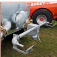
**SYSTÈME D'ASPERSION:** Système d'aspersion à l'arrière de la tonne. Idéal pour la suppression de la poussière, les travaux routiers et l'augmentation du volume de liquide épandu.
