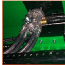
**DÉTECTION DE CHARGE HYDRAULIQUE:** Sur des systèmes hydrauliques spécifiques, la détection de charge hydraulique (ou la puissance au-delà) garantit que le débit d'huile est fourni selon les besoins. Il s'agit d'un système hydraulique plus puissant et plus économe en carburant, fournissant de l'huile à la demande.
