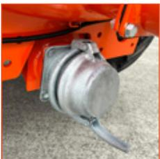
**BAC A PIERRES:** Bac à pierre avec raccord Bauer. Situé à la base de la tonne, à l'arrière, sous la cuve, pour récupérer les pierres et autres corps étrangers indésirables.
