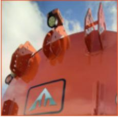
**SUPPORT DE MONTAGE POUR APPLICATEUR:** Les tonnes encastrées sont équipées en série des supports pour la rampe à pendillards et la rampe à patins Agri Pro. Les supports pour la rampe à patins Premium Plus et l'injecteur à disques sont disponibles sur demande.
